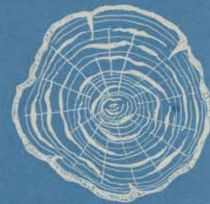
Difetto di cipollatura.
