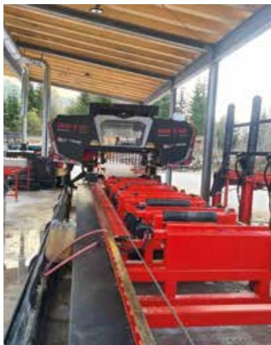
ad azionamento idraulico, dotate di lama verticale cosiddetta "alla veneziana".
