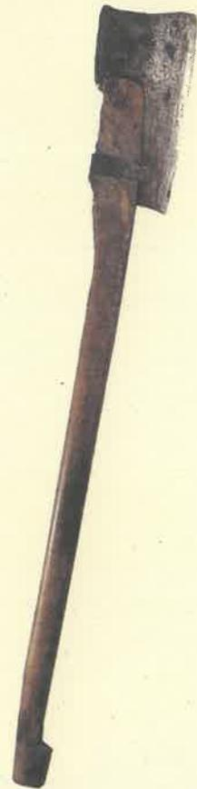
Dai tronchi si ricavavano le travi a sezione quadrata, *šcuairàde*, con un apposita scure, *manèra da šcuairà*, che era fatta in maniera da poter lavorare il tronco sia di destro che di sinistro.
